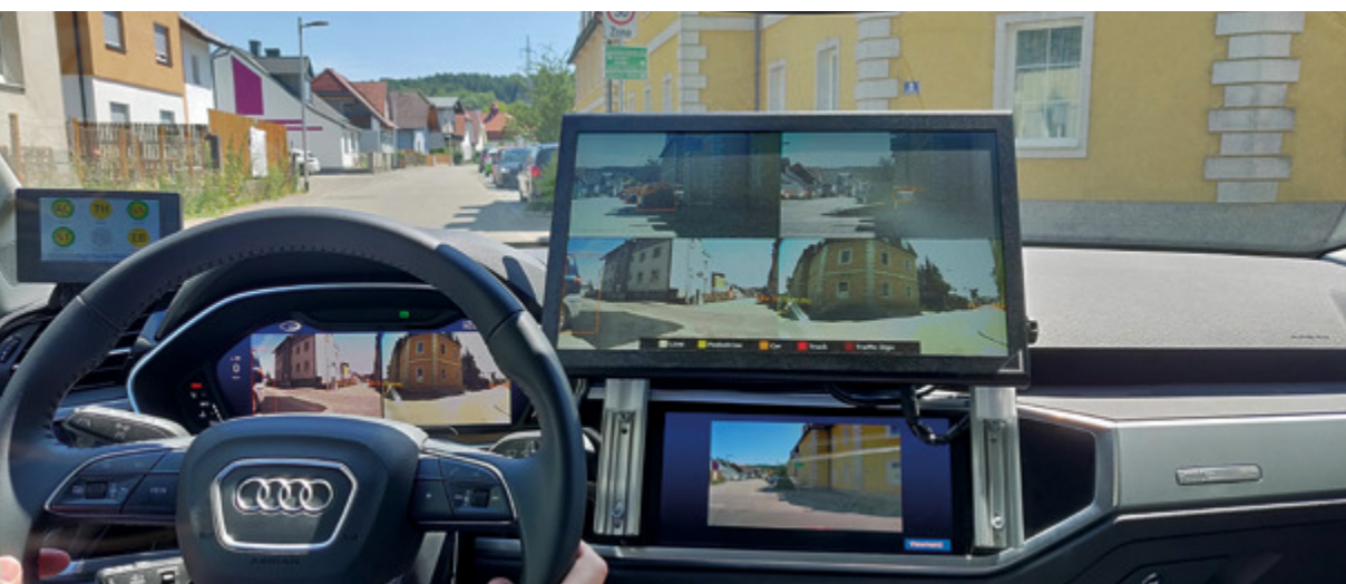
^ Abb. 14 – Innenraum mit Testmonitoren © ZKW
