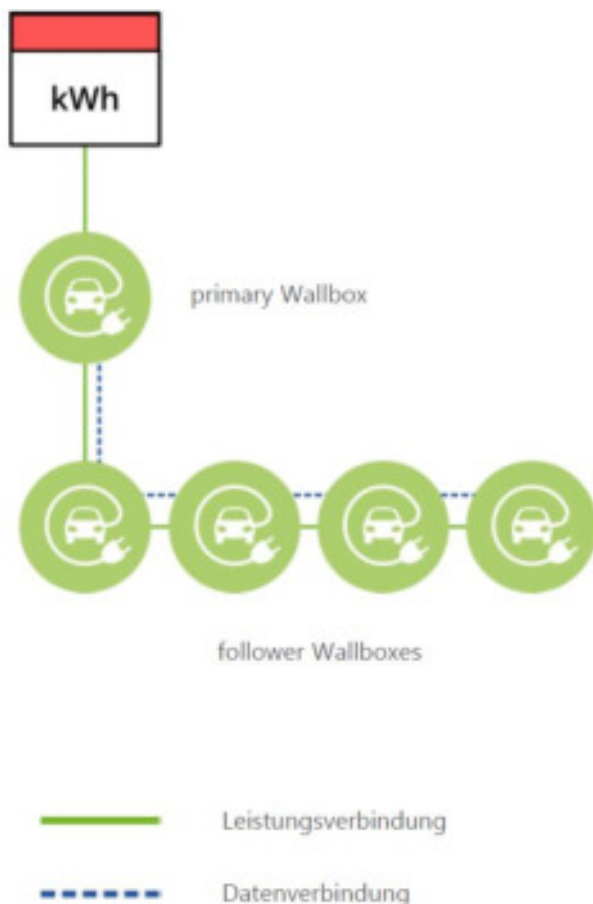
Abbildung 17: Technische Umsetzung des lokalen Lastmanagements. (Energie Kompass | act4.energy)
