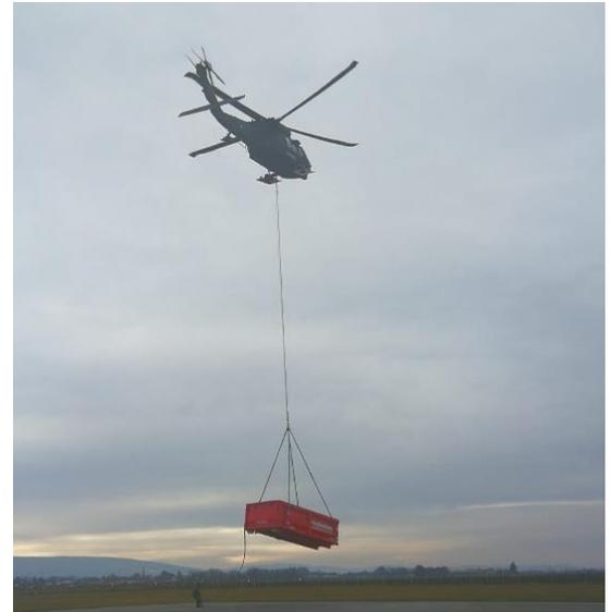
Multifunktionaler, offener Abrollcontainer (AB) im Format 20 Fuß (Länge ca. 6,40 m) zum Transport mit Wechselladefahrzeug (WLF) mit Multilift-Hakengerät geeignet. „Flugtauglich“
