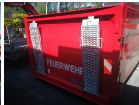
Rückwand, Schwenktür rechts öffnend, inkl. Auffahrschienen
