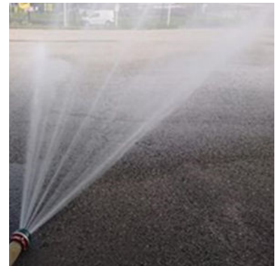
Abbildung 6: Blindkupplung mit Bohrungen
