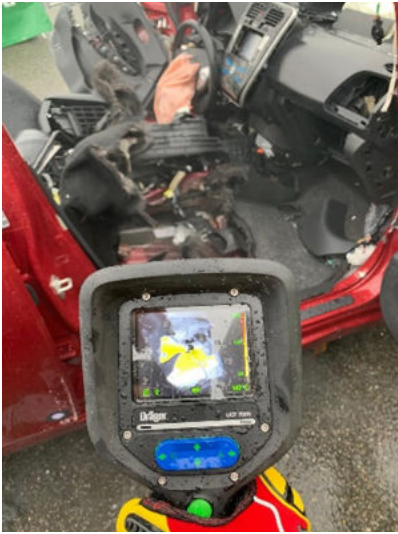
Abbildung 11: Temperaturkontrolle mittels WBK
