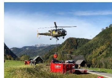
Befüllen mittels Löschbehälter und Hubschrauber
