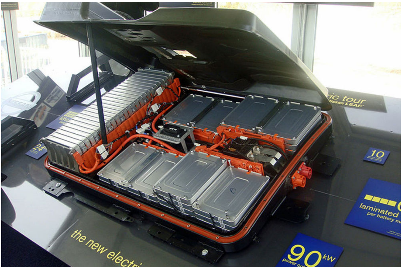
Abbildung 3: HV-Batterie-Pack Nissan Leaf
