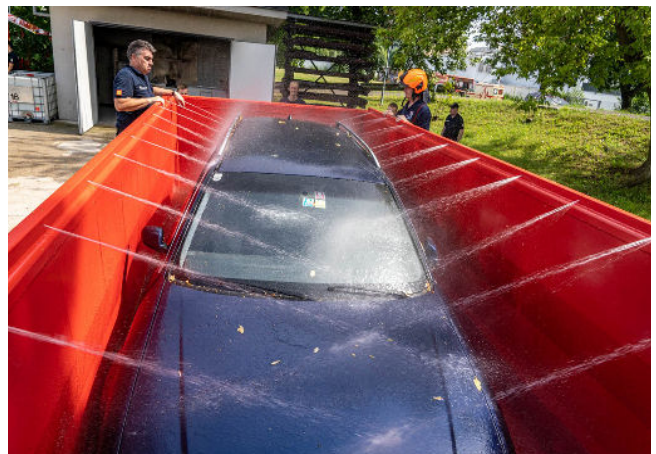
Abbildung 10: Sprinklung eines PKW's in der AB Mulde
