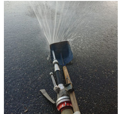
Abbildung 5: Strahlrohr mit Fassschaufel als Prallblech
