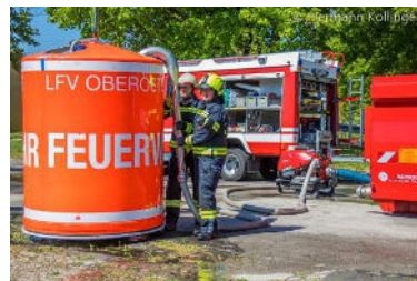
Wasserentnahme über TS in Löschbehälter
